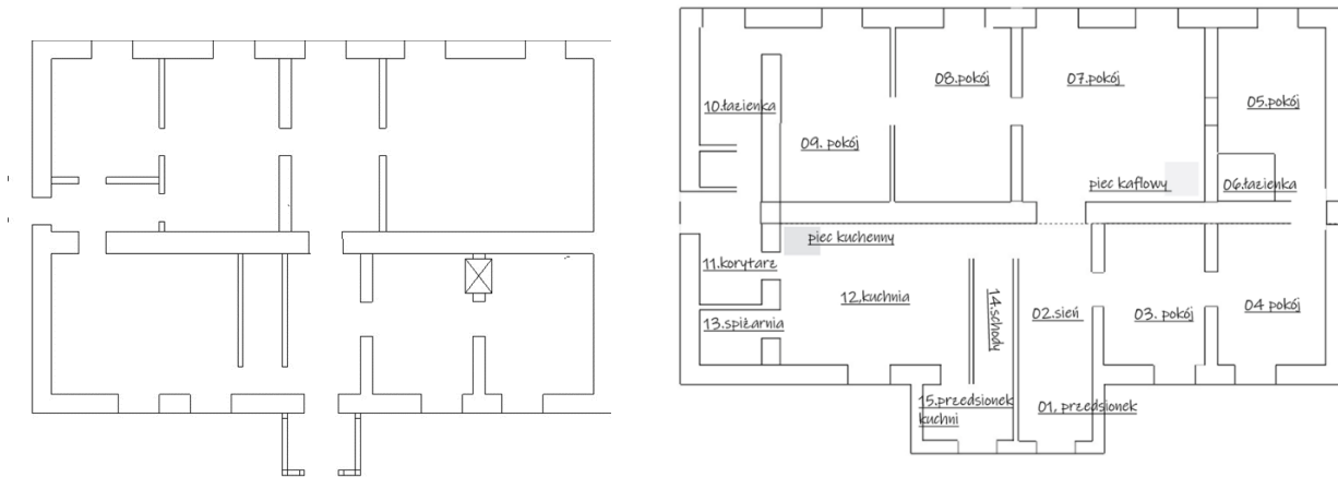
Schemat parteru budynku na podstawie rysunku dotyczącego planowanej przebudowy z 1878 r. ( po lewej). Schemat budynku z oznaczonym aktualnym układem pomieszczeń ( po prawej)
